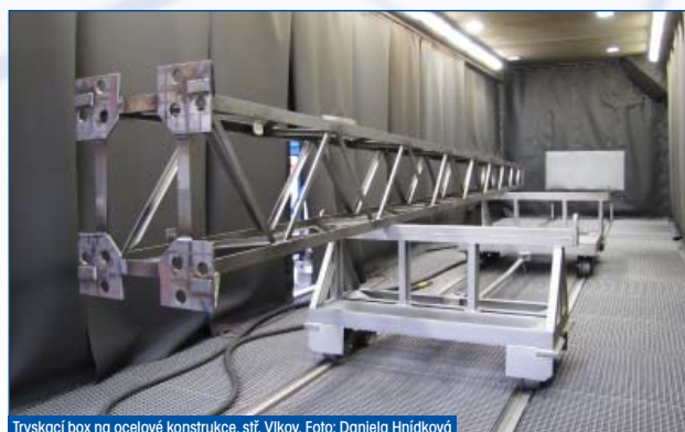
Tryskáci box na ocelové konstrukce, stf. Vlkov. Foto: Daniela Hnídková
