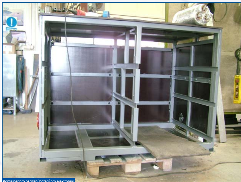
Kontejner pro osazení baterií pro elektrobuses
