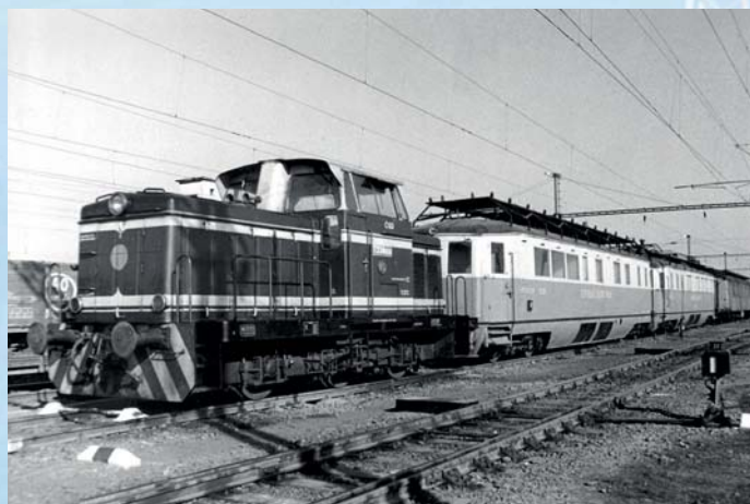
Dvojice škodovských Modřých šípů upravených na montážní vozy tažená Rosničkou T 334.0
